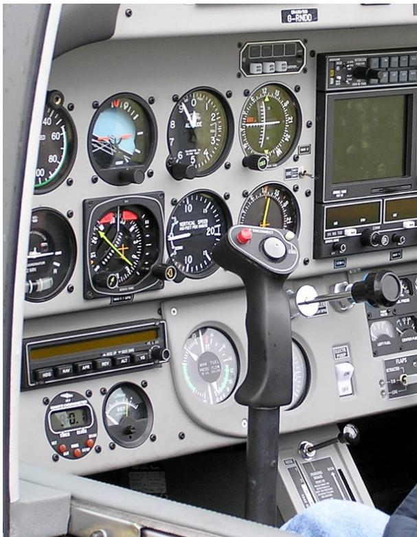
**Bild 6.13** Steuerknüppel in einer Robin DR 400
