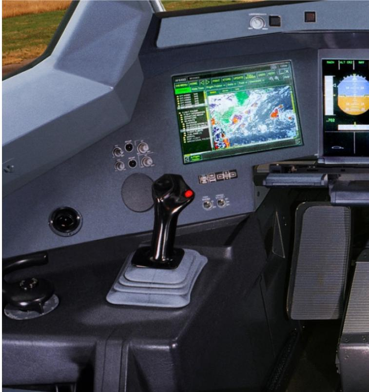
**Bild 6.16** Sidestick des Airbus A350 – irreversible Flugsteuerung, FBW. Rechts im Bild: Das linke der beiden Seitenrudderpedale (Quelle: Hanser Verlag)
