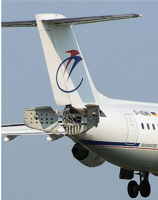
**Bild 6.26** Bremsklappen (air brakes) ausgefahren am Heck eines Flugzeugs
