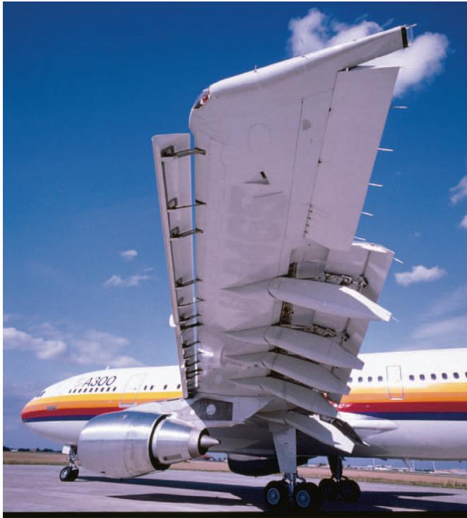
**Bild 6.21** Landeklappen (flaps) an der Hinterkante des Flügels und Vorflügel (slats) an der Vorderkante des Flügels am Airbus A300 (Quelle: Hanser Verlag)
