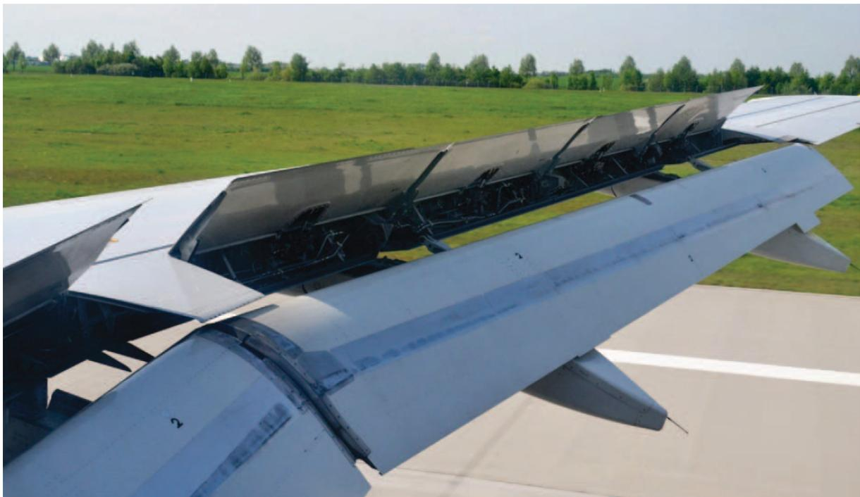
**Bild 6.27** Störklappen (spoiler) befinden sich hinter dem Hinterholm am Flügel und werden nach oben ausgeschlagen (Quelle: Hanser Verlag)
