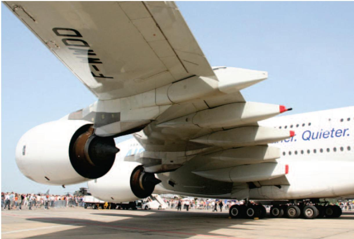
**Bild 6.25** Die aerodynamischen Verkleidungen der Landeklappenkinematik werden als Flap Track Fairings bezeichnet (Quelle: Hanser Verlag)
