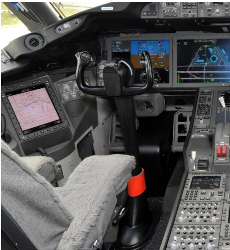
**Bild 6.17** Steuerhorn in der Boeing 787 – irreversible Flugsteuerung, FBW. Ebenfalls sichtbar: Die beiden Seitenrudderpedale (Quelle: Hanser Verlag)
