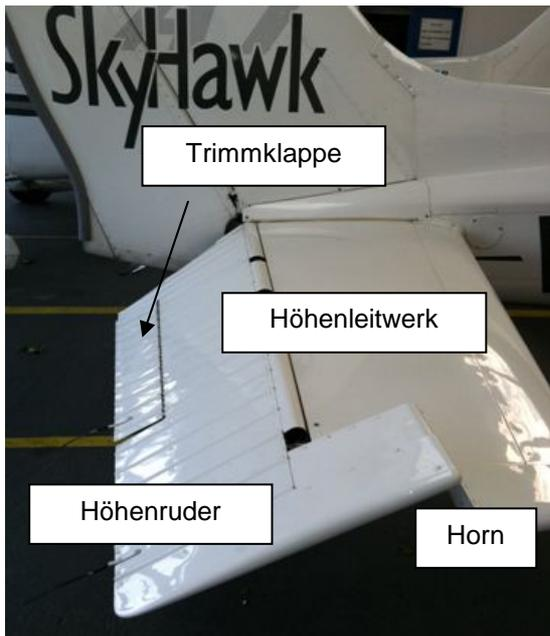
**Bild 6.5** Trimmung und Steuerung um die Nickachse bei kleinen Flugzeugen
