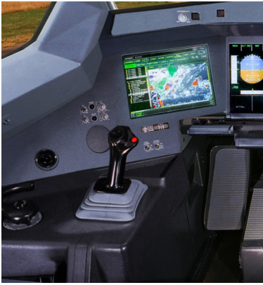
Bild 5 Sidestick des Airbus A350 – irreversible Flugsteuerung, FBW
