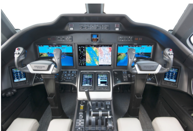
Bild 4 Steuerhorn in der Cessna Citation X – irreversible Flugsteuerung, mechanische Signalübertragung
