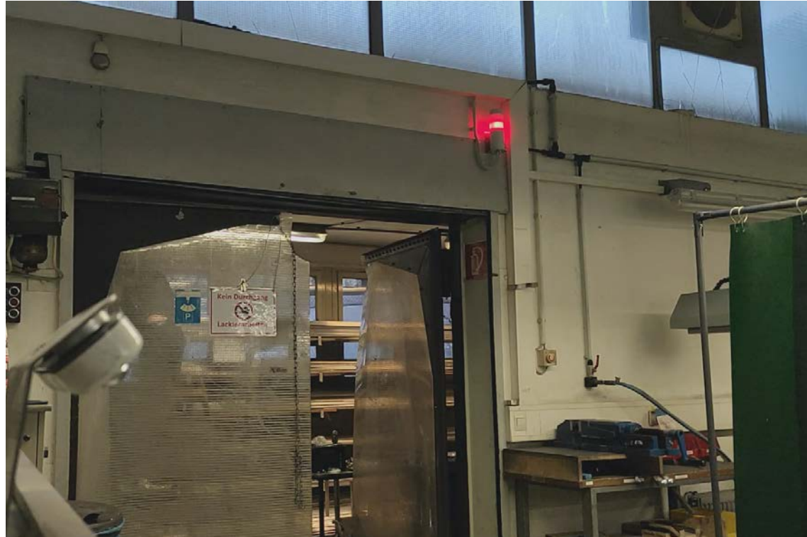
Verschiedene LED-Lampen zeigen den Status der Lackierkabine an und geben dem/der MitarbeiterIn eine direkte Rückmeldung bei der Maskenerkennung © Innovint
