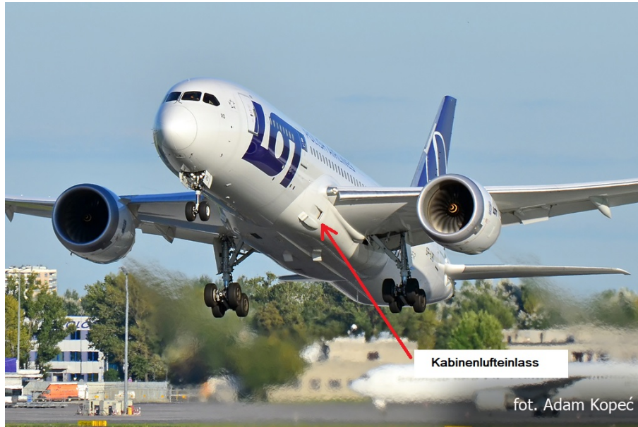
Abbildung 7.4.: Entnahmestelle der Kabinenluft bei einer B787 [49], bearbeitet mit Paint
