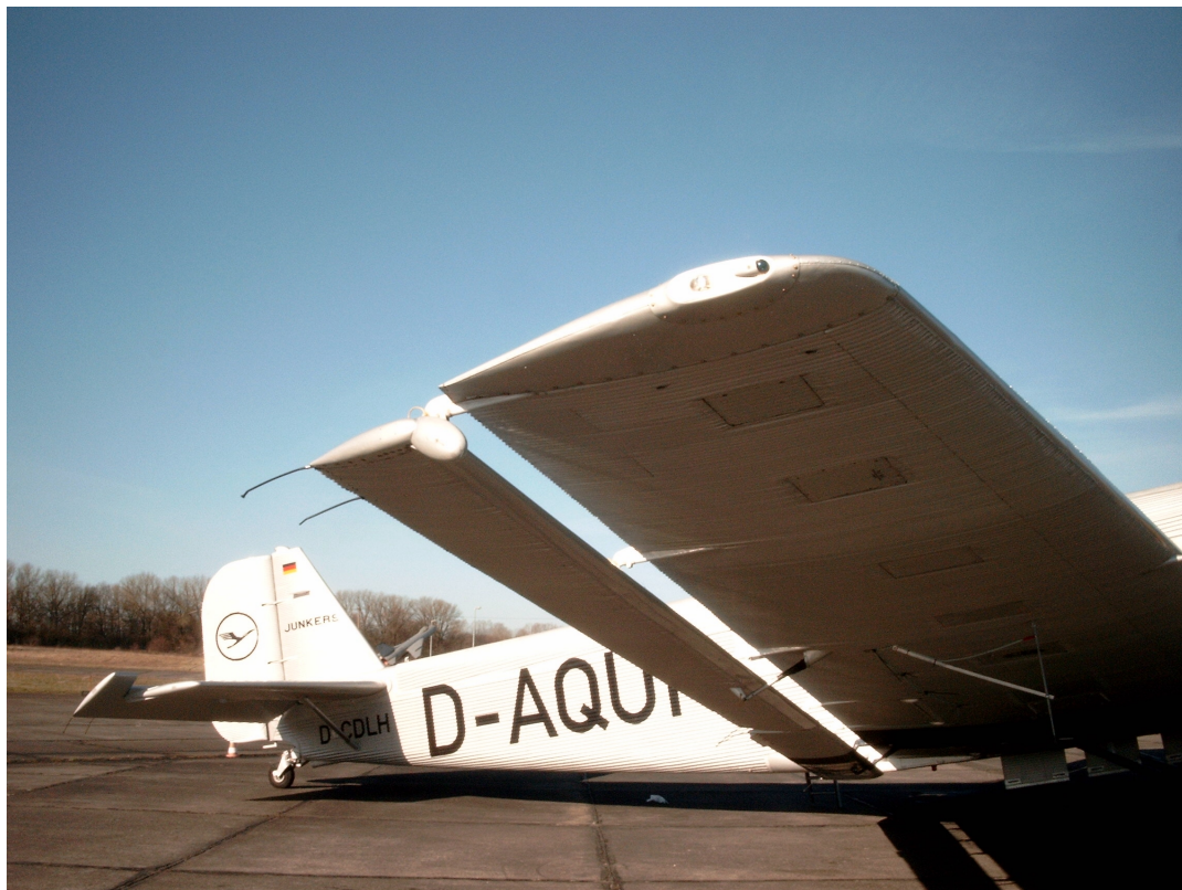
Bild E.4 Doppelflügel mit Staurohr freie Strömung
