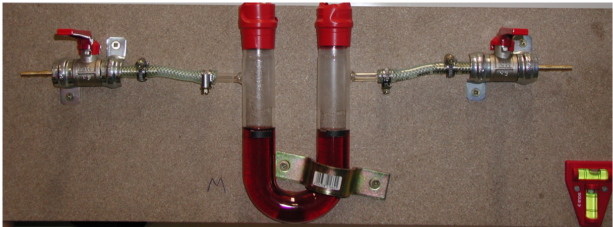
Bild E.6 U-Rohr
