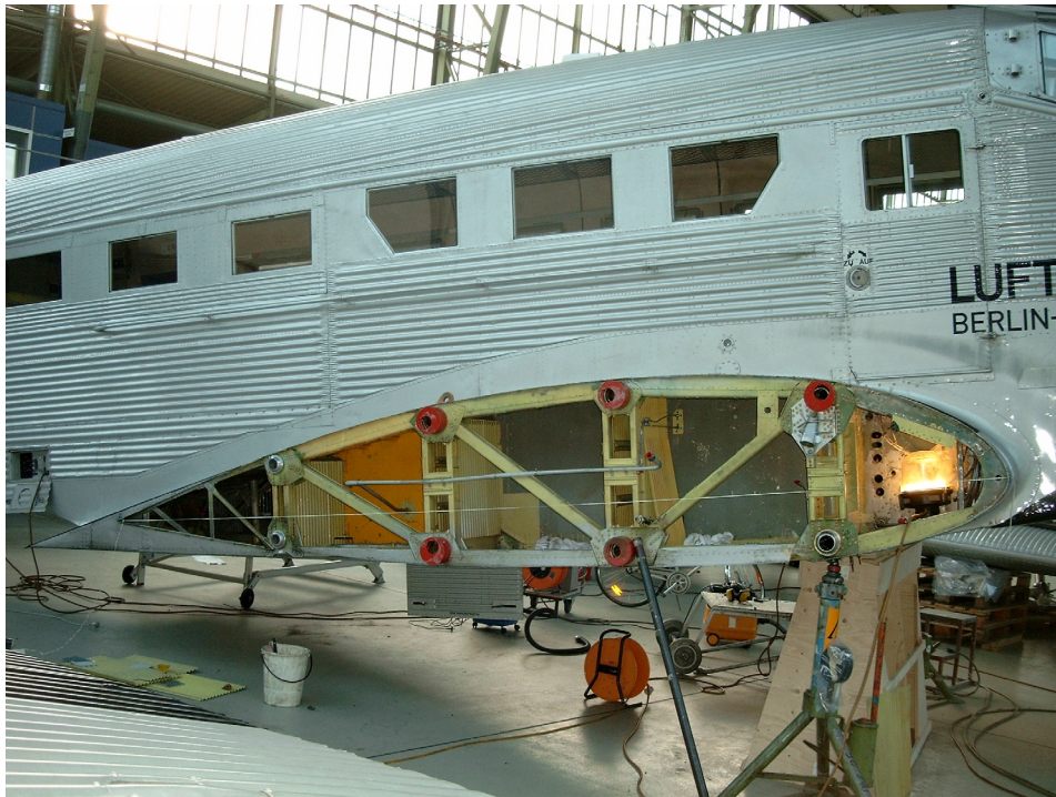
Bild E.1 Profilvermessung mit Sehne
