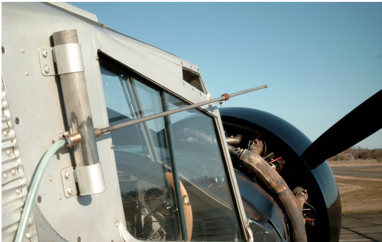
Bild 4.4 Staurohr Propellerströmung – Anbau
