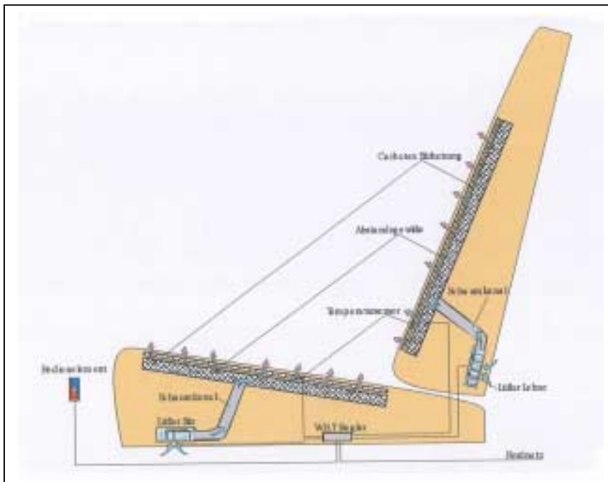
Bild 2.17 Querschnittzeichnung eines klimatisierten Fahrzeugsitzes (W.E.T.2000b)
