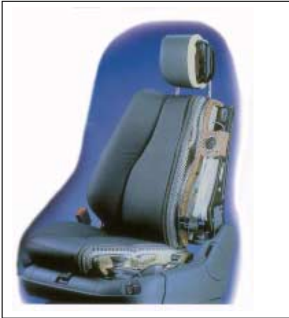
Bild 2.16 Klimatisierter Fahrzeugsitz (Papst)
