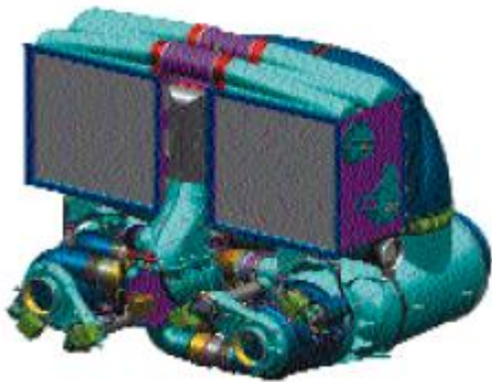
Bild 5.9 Klimapack (AGU) der Airbus A380 ( Flightinternational 2003 )
