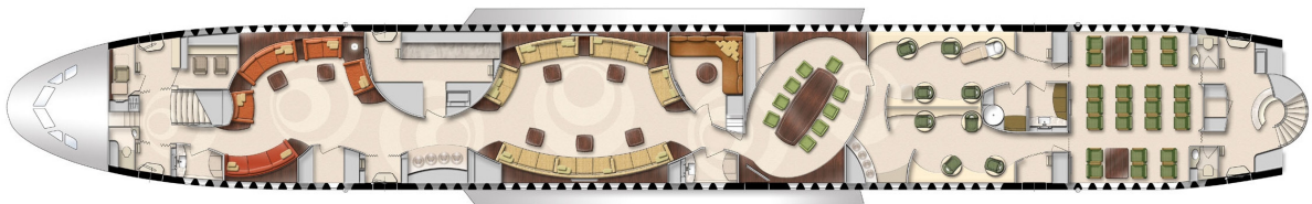
Bild 3.1 Layout des Main Decks (LHT 2005)
