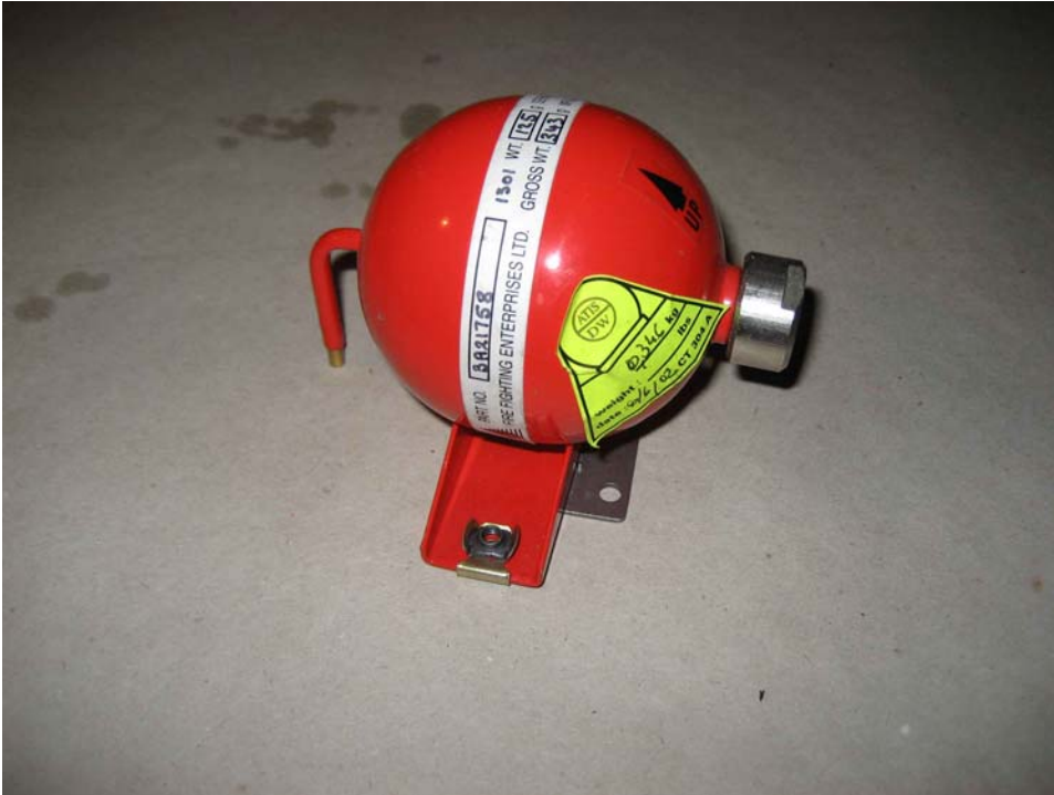
Bild A.7 Halonlöschbehälter
