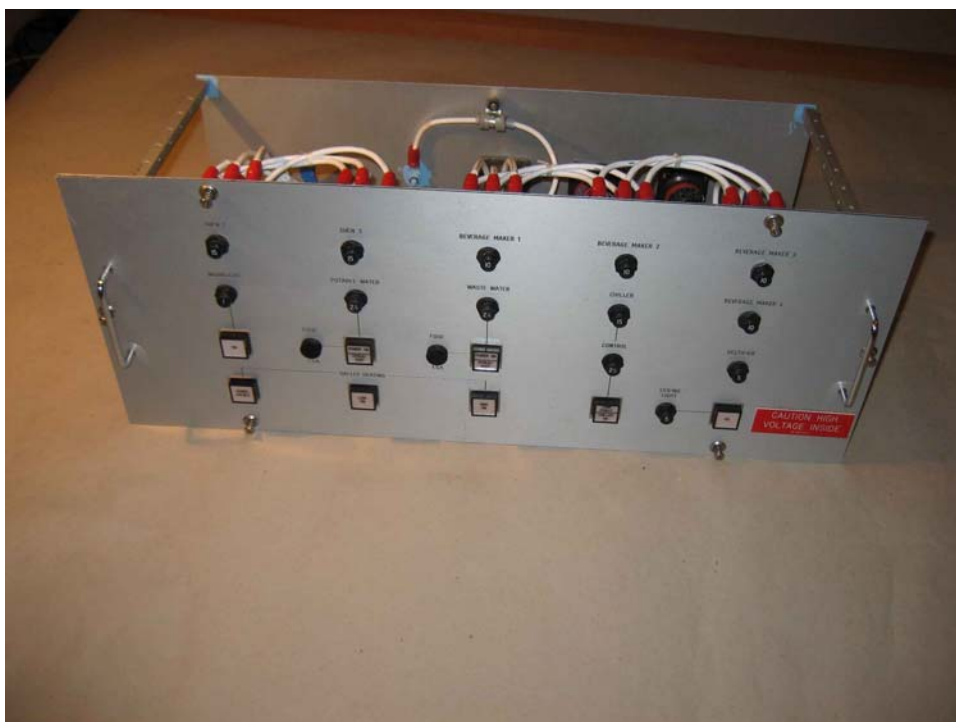
Bild A.10 Galley Control Unit
