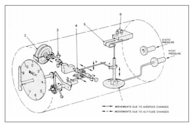
Fig.: 5-7 The analog mach meter (Bräunling)
