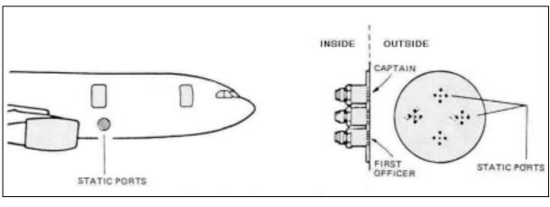
Fig.: 4-2 The static port (Bräunling)
