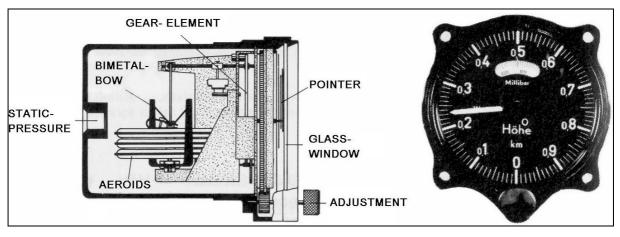
Fig.: 5-4 The analog altimeter (Götsch 1989)
