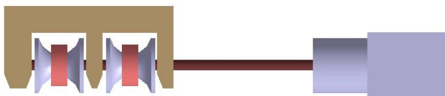
Abbildung 44: Obere Führungsschiene – Seitenansicht mit Elektromotor
