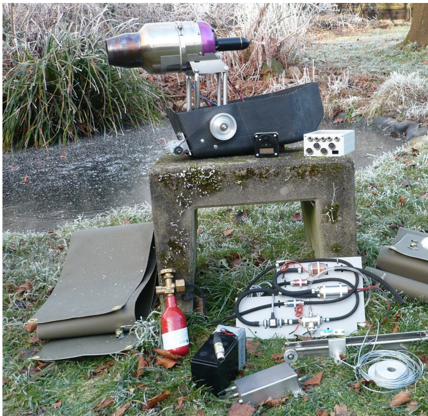
Abb. 5.7 Umbausatz für ein nachrüstbares Strahltriebwerk (Klaus Meitzner 2007)
