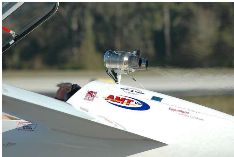
Abb. 2.12 Triebwerksintegration Silent-J (Bob Carlton)
