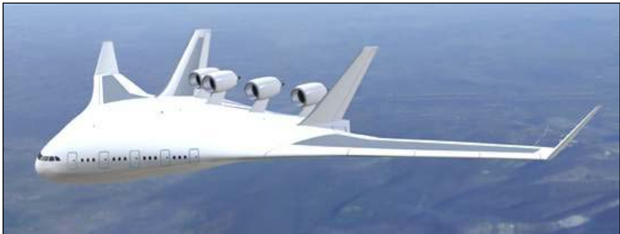
Bild 1.2 Beispiel für eine BWB-Flugzeugkonfiguration ( Flug Revue 2001 )
